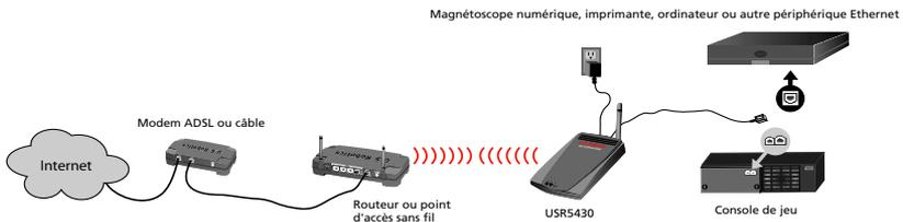
Le mode Ad hoc (quelquefois désigné comme mode d'égal à égal) est un type de réseau sans fil qui permet à un adaptateur sans fil ou à un équipement Ethernet de se connecter directement à un autre adaptateur sans fil ou équipement Ethernet. L'illustration ci-dessous présente un exemple de réseau en mode Ad hoc.
