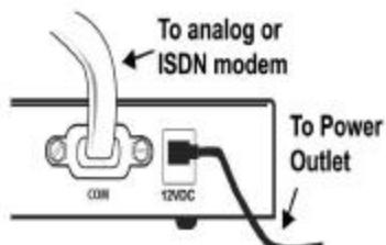
Conekte o fio de energia à tomada elétrica do Broadband Router. Conekte o fio de energia a uma tomada elétrica padrão. O Broadband Router entra automaticamente na fase de autoteste. Ligue o PC e o modem analógico ou ISDN.
