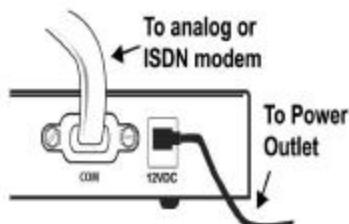
Conecte el cable de alimentación suministrado al conector de alimentación del Broadband Router. Enchufe el cable de alimentación a una toma de corriente estándar. El Broadband Router entrará automáticamente en la fase de autopregunta. Encienda la PC y el módem analógico o ISDN.
