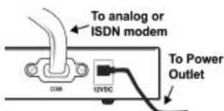
Apague la PC y el módem analógico o ISDN.
