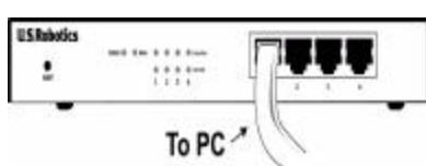
Connectez une extrémité d'un câble Ethernet à la carte Ethernet du PC. Connectez l'autre extrémité du câble à l'un des ports LAN du Broadband Router.
