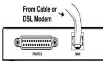
Desligue o PC e o modem a cabo ou DSL.
