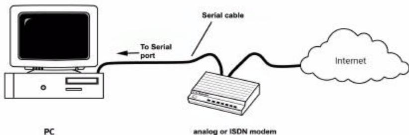
Suivez les étapes suivantes pour connecter un modem analogique ou RNIS, changer manuellement le type de réseau étendu (WAN) et configurer correctement le Broadband Router:
