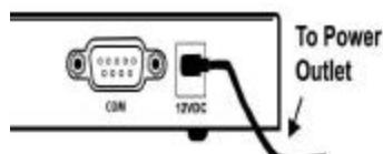
Encienda el módem de cable o DSL. Conecte el cable de alimentación suministrado al conector de alimentación del Broadband Router. Enchufe el cable de alimentación a una toma de corriente estándar. El Broadband Router entrará automáticamente en la fase de autopregunta. En cuanto acabe la autopregunta, encienda la PC.
