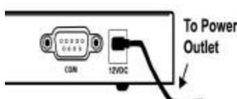
Ligue o modem a cabo ou DSL. Conecte o fio de energia à tomada elétrica do Broadband Router. Conecte o fio de energia a uma tomada elétrica padrão. O Broadband Router entra automaticamente na fase de autoteste. Depois que a fase de autoteste estiver correta, ligue o PC.
