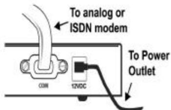
Branchez le câble d'alimentation fourni dans la prise d'alimentation du Broadband Router. Branchez le cordon d'alimentation dans une prise murale standard. Le Broadband Router déclenche automatiquement un auto-test. Éteignez l'ordinateur et le modem analogique ou RNIS.
