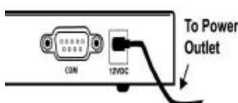
Mettez le modem câble ou DSL sous tension. Branchez le câble d'alimentation fourni dans la prise d'alimentation du Broadband Router. Branchez le cordon d'alimentation dans une prise murale standard. Le Broadband Router déclenche automatiquement un auto-test. Quand la phase d'auto-test est terminée, allumez l'ordinateur.
