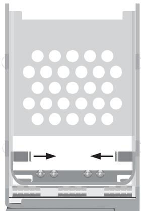
3. Avec l'extrémité plate de l'entretoise orientée vers le haut et les vis face à une surface plate (une table ou le dessus d'un bureau, par exemple), pliez les côtés de l'entretoise pour desserrer les vis.
