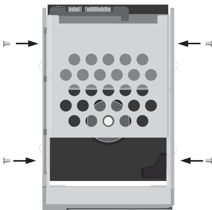
6. Remplacez le disque dur et son tiroir dans le système de stockage jusqu'à ce qu'ils s'emboîtent parfaitement.
