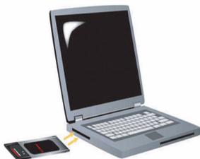
Finn et ledig PC-kortspor og sett inn PC-kortet 22 Mbps Wireless PC Card ordentlig. PC-kortspor er vanligvis plassert på siden av bærbar maskiner. Du skal høre et signal når kortet 22 Mbps Wireless PC Card er satt inn og gjenkjent.
