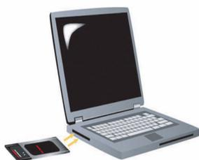
Inserte la PC Card en la ranura correspondiente. Las ranuras para las PC Card están normalmente en el lateral de los ordenadores portátiles. Deberá de escuchar un pitido cuando la tarjeta 22 Mbps Wireless PC Card esté insertada del todo.
