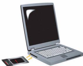
Kijk of er een aansluiting voor de PC Card beschikbaar is en plaats de 22 Mbps Wireless PC Card daar helemaal in. Aansluitingen voor PC Cards bevinden zich meestal aan de zijkant van laptops. Er klinkt een pieptoon als de 22 Mbps Wireless PC Card goed aangesloten is en opgemerkt wordt.
