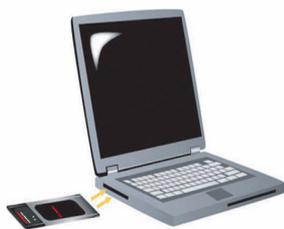
Найдите свободный слот PC Card и полностью вставьте в него плату 22 Mbps Wireless PC Card. Слоты PC Card обычно находятся на боковой панели портативных компьютеров. После того, как плата 22 Mbps Wireless PC Card будет полностью вставлена и обнаружена, раздастся звуковой сигнал.
