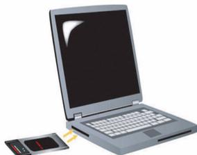
Suchen Sie einen freien PC-Karten-Steckplatz und stecken Sie die 22 Mbps Wireless PC Card ganz hinein. PC-Karten-Steckplätze befinden sich normalerweise an der Seite eines Laptop-Computers. Sie sollten einen Signalton hören, wenn die 22 Mbps Wireless PC Card richtig eingesetzt und erkannt wurde.
