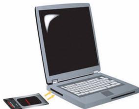
Individuare uno slot per PC Card disponibile e inserirvi 22 Mbps Wireless PC Card. Gli slot per PC Card si trovano solitamente sui lati dei laptop. Un segnale acustico indica che 22 Mbps Wireless PC Card è inserita correttamente ed è stata rilevata.
