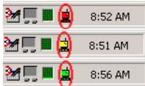
Du måste nu konfigurera varje dator med en 22 Mbps Wireless PCI Adapter så att Internet-anslutning, filer och skrivare kan delas mellan dem. Dubbelklicka på verktygsikonen så att Configuration Utility startas. Läs avsnittet 22 Mbps Wireless Configuration Utilities i användarhandboken på installationsskivan om du behöver utförlig konfigureringsinformation.
