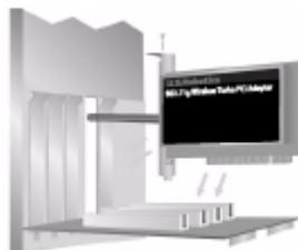
Befestigen Sie den 802.11g Wireless Turbo PCI Adapter mit der zuvor entfernten Schraube bzw. Klammer. Setzen Sie das Computergehäuse wieder auf und schalten Sie Ihren Computer ein.
