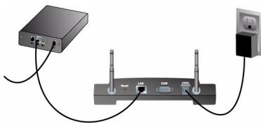
A vezeték nélküli hozzáférési pont három LED-es állapotkijelzővel rendelkezik, ezek: TX/RX, WARN, és POWER. Ha a vezeték nélküli hozzáférési pontot csatlakoztatta a táphálózathoz a PWR LED világít. Ha a helyi hálózati kapcsolat felépült, a TX/RX LED világít. Amennyiben jogosulatlan felhasználó kíséri meg használni a 802.11g Wireless Turbo Multi-function Access Point-ot, a WARN LED világít.
