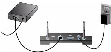
Punkt bezprzewodowego dostępu ma trzy diody świecące stanu: PWR, TX/RX i WARN. Gdy punkt bezprzewodowego dostępu jest włączony, świeci dioda PWR. Po ustanowieniu połączenia z siecią świeci dioda TX/RX. Jeśli z punktu dostępu 802.11g Wireless Turbo Multi-function Access Point usiłuje korzystać użytkownik do tego nieuprawniony, świeci dioda WARN.
