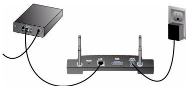
O Wireless Access Point conta com três LEDs de indicação de estado: PWR, TX/RX e WARN (aviso). Quando o Wireless Access Point está ligado, o LED PWR (ligado) ilumina-se. Quando for estabelecida uma ligação à rede, o LED TX/RX (transmissão/recepção) acende-se. Se um utilizador não autorizado tentar utilizar o 802.11g Wireless Turbo Multi-function Access Point, o LED WARN (aviso) acende-se.
