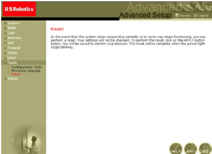
Haga clic en **APPLY** (Aplicar) para reiniciar el 802.11g 54Mbps Router. El proceso se habrá completado cuando el LED de alimentación deje de parpadear.
