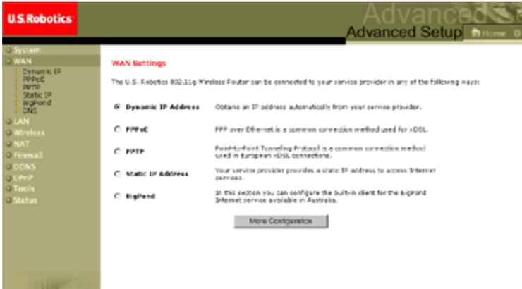
Indique el tipo de conexión WAN proporcionado por su proveedor de acceso a Internet y, a continuación, haga clic en **More Configuration** (Más parámetros de configuración) para introducir los datos de configuración del tipo de conexión seleccionado.
