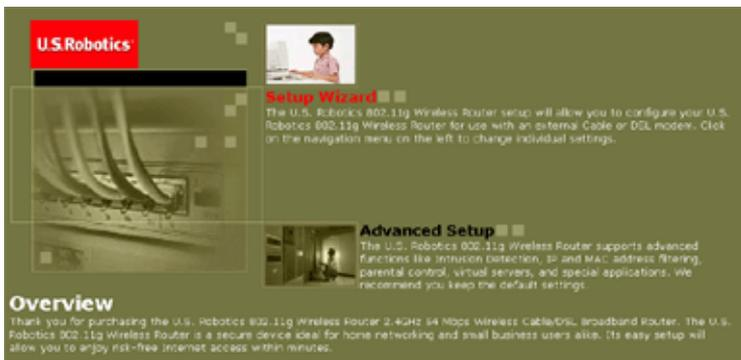
La interfaz del usuario del 802.11g 54Mbps Router cuenta con un **Setup Wizard** (Asistente de instalación) y una sección de **Advanced Setup** (Configuración avanzada). Use el asistente de instalación si desea configurar rápidamente el 802.11g 54Mbps Router para usarlo con un módem de cable o DSL.
