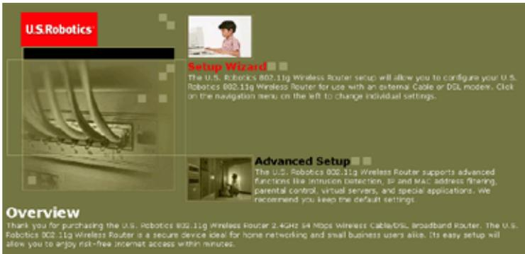
L'interface utilisateur du routeur 802.11g 54Mbps Router contient un assistant d'installation et des options d'installation avancée. Utilisez l'assistant d'installation si vous souhaitez installer rapidement le routeur 802.11g 54Mbps Router, et l'utiliser avec un modem câble ou DSL.
