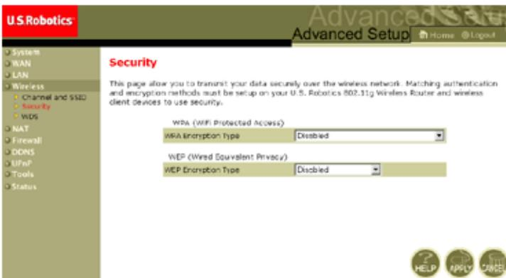
Si vous transmettez des données sensibles sur des canaux sans fil, il est conseillé d'activer le cryptage WAP (Wi-Fi Protected Access) ou WPE (Wired Equivalent Privacy). La sécurité par cryptage requiert l'utilisation du même ensemble de protocoles (WAP ou WEP) et des mêmes clés de cryptage et de décryptage pour le routeur 802.11g 54Mbps Router et tous vos clients sans fil.
