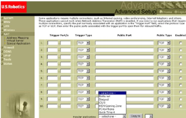
Spécifiez le numéro de port public normalement associé à une application dans le champ Trigger Port (Port déclencheur). Définissez le type de protocole sur TCP ou UDP, puis spécifiez les ports requis par l'application.
