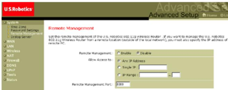
L'administration à distance permet à un PC distant de configurer, gérer et contrôler le routeur 802.11g 54Mbps Router à l'aide d'un navigateur Web standard. Cochez la case **Enable** (Activer), puis indiquez la ou les adresses IP de l'hôte distant. Cliquez sur **APPLY** (Appliquer). (Par défaut : désactivé)
